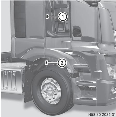
Fahrzeug-Identifizierungsnummer (FIN) und Fahrzeugtypschild (Beispiel Actros Fahrerhaus mit ebennem Boden)
