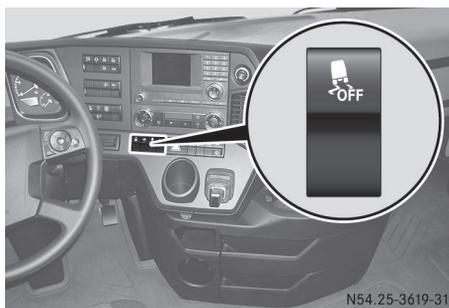
Wenn Sie den Motor starten, ist der Stabilitätsregel-Assistent automatisch eingeschaltet.
