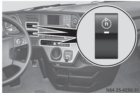
Wenn die Drehzahl-Konstanthaltung eingeschaltet ist, regelt die Elektronik die programmierte Arbeitsdrehzahl des Nebenabtriebs unabhängig von der Belastung.
