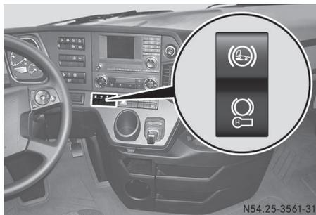
Die Haltestellenbremse hat gegenüber der Feststellbremse einen geringeren Druckluftverbrauch. Wenn Sie häufig anfahren und kurzzeitig anhalten, benutzen Sie die Haltestellenbremse, z. B. im Müllsammelbetrieb. Die Haltestellenbremse ersetzt weder die Betriebsbremse noch die Feststellbremse. Wenn Sie Ihr Fahrzeug abstellen wollen, finden Sie Informationen im Abschnitt „Anhalten und Abstellen“ (▷ Seite 239).
