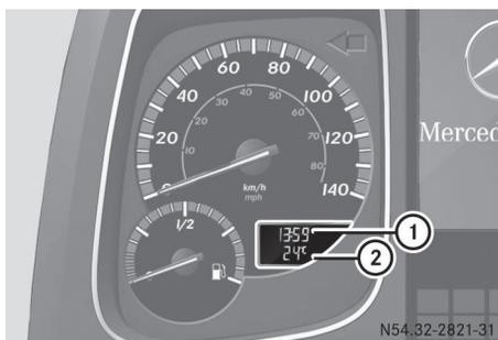
Kombiinstrument (Beispiel Display im Tachometer)
