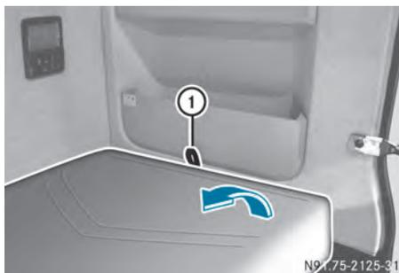
Belasten Sie den Rückenhochsteller mit maximal 500 N (entspricht 50 kg).
