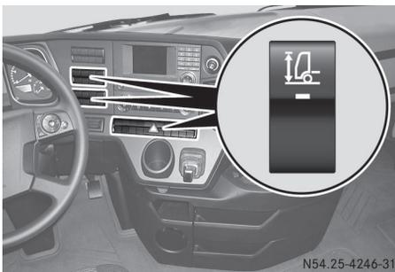
Heben Sie zur Verbesserung des Federungskomforts den Fahrgestellrahmen im Fahrbetrieb an.
