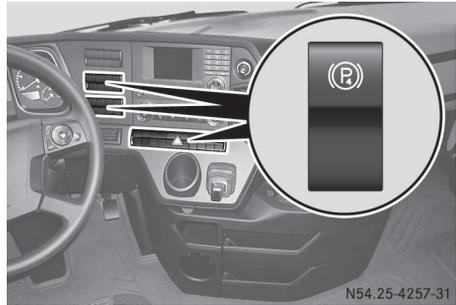
Die Vierrad-Feststellbremse koppelt die Betriebs- und die Feststellbremse elektro-pneumatisch. Die Vierrad-Feststellbremse dient zur sicheren Abstützung von Feuerwehrfahrzeugen, z. B. bei Bergungsarbeiten mit der Seilwinde.
