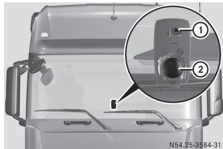
Wenn Sie die Frontscheibe regelmäßig im Bereich des Regen- und Lichtsensors ② und der Kamera ① reinigen, vermeiden Sie Funktionsstörungen.
