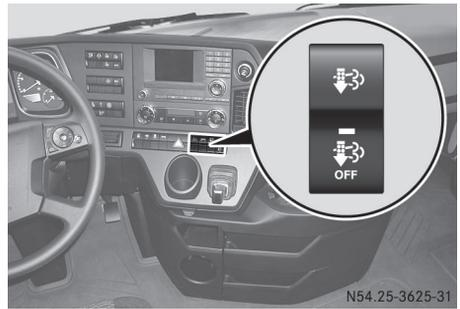
Die manuelle Regeneration dauert etwa 30 bis maximal 60 Minuten.
