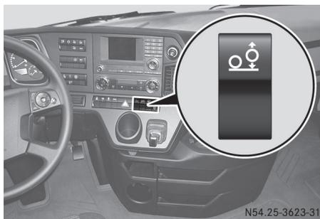
Die Vorlauf-/Nachlaufachse senkt sich kurz vor Erreichen der zulässigen Achslast ab. Beachten Sie die Hinweise im Abschnitt „Achs- und Radlasten“ (▷ Seite 264) und auf dem Fahrzeugtypschild (▷ Seite 424).
