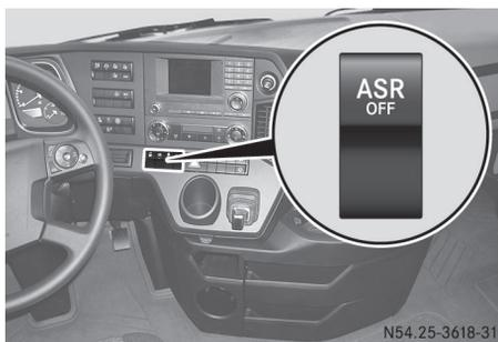
Fahrzeuge mit Stabilitätsregel-Assistent besitzen keine Taste
