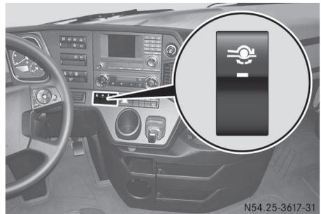
Sie können mit der Fahrfunktion Freischaukeln das Fahrzeug in allen zulässigen Anfahr­gängen aus einer Geländevertiefung herausschaukeln. Wenn Sie im Freischaukeln das Fahrpedal loslassen, trennt die Trockenkupplung schlagartig und das Fahrzeug rollt zurück. Wenn Sie erneut das Fahrpedal niedertreten, schließt die Trockenkupplung sofort und das Fahrzeug fährt an.
