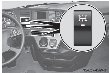
Schalter Nebenabtrieb (Beispiel getriebeabhängiger Nebenabtrieb 1)
